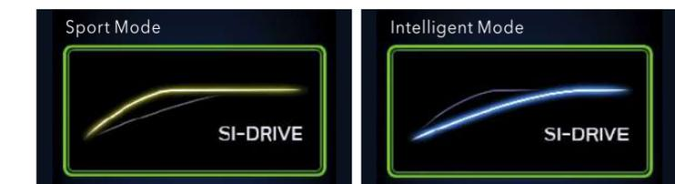
Система Subaru Intelligent Drive (SI-DRIVE) позволит управлять автомобилем с учетом вашего стиля вождения при любых дорожных условиях. «Интеллектуальный» режим идеален для ежедневных поездок и характеризуется плавным изменением крутящего момента и минимальным расходом топлива. Режим Sport обеспечивает четкий отклик двигателя на любой скорости движения. При нажатии на педаль акселератора вы моментально почувствуете обратную связь и высокий крутящий момент.
